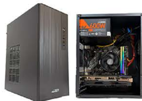
COOLER DE 80MM EN LA PARTE TRASERA, METAL FUERTE DE 0.80 MM
